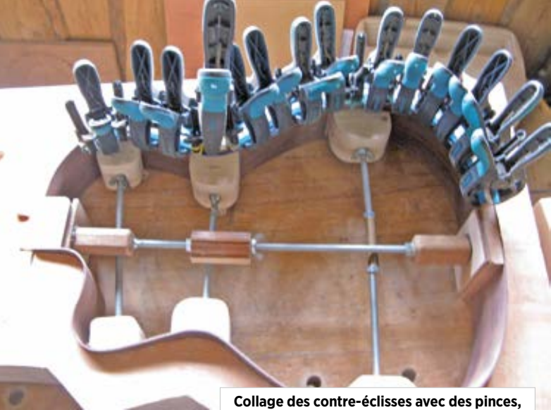
Collage des contre-éclisses avec des pincettes, efficaces et facilement disponibles
