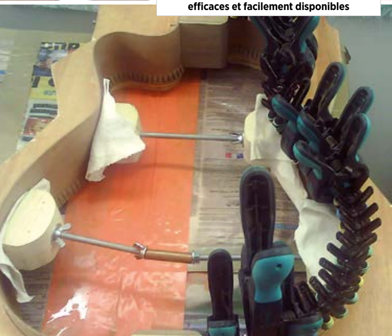
Collage des contre-éclisses avec des pincettes, efficaces et facilement disponibles
