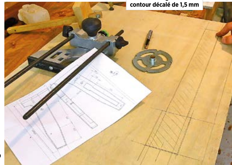
Tracé du gabarit : contour décalé de 1,5 mm
