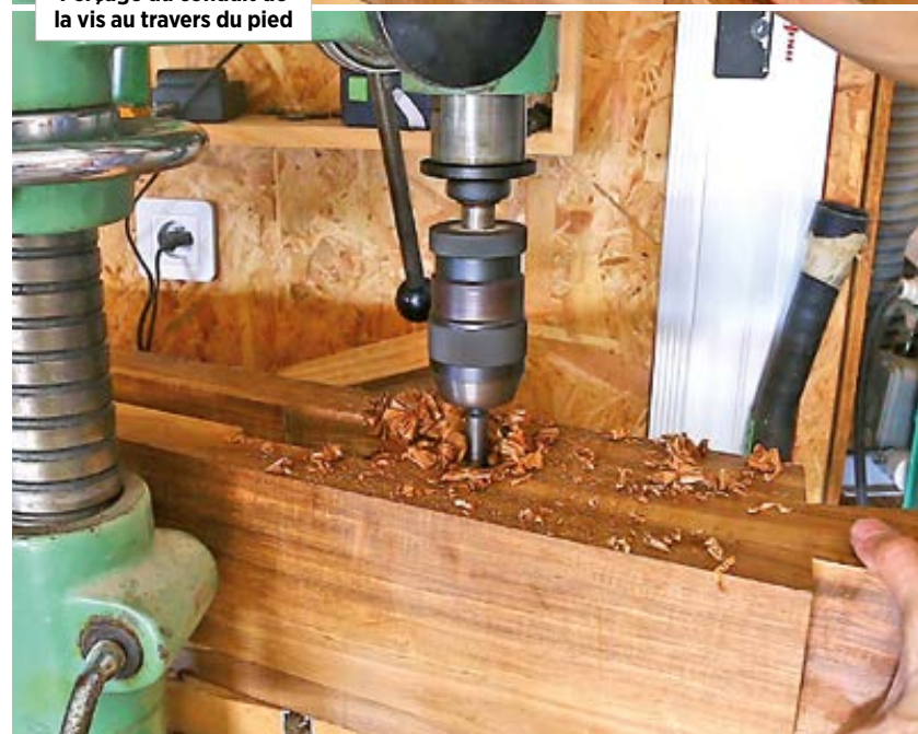
Perçage du conduit de la vis au travers du pied
