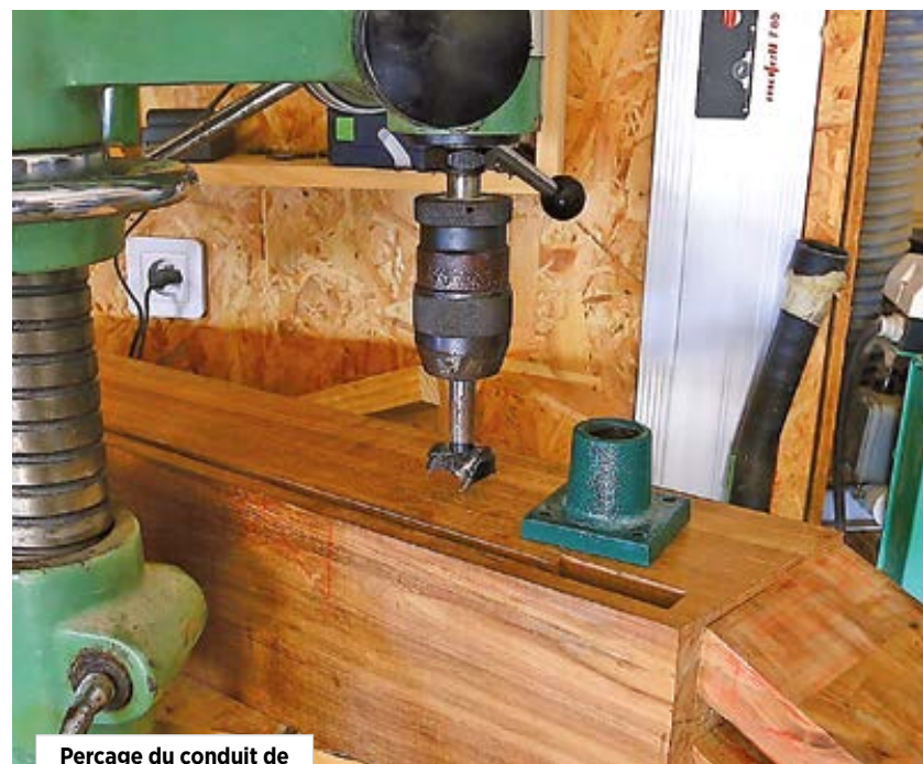
Perçage du conduit de la vis au travers du pied
