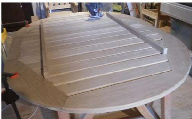
Le montage est terminé. Le tout est poncé, principalement pour enlever les quelques traces de colle. Un usinage à la défonceuse, munie d'une fraise à roulement de type quart-de-rond adoucit les arêtes vives, notamment sur le pourtour de la table et les pieds.
