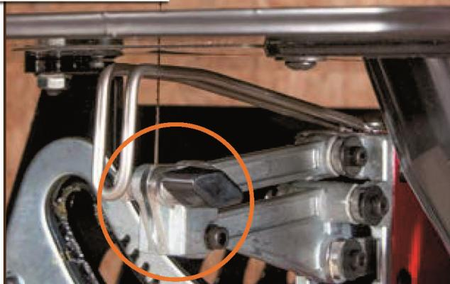
se font donc simplement en desserrant des vis à la main, aussi bien en partie haute qu'en partie basse. Les découpes fermées ne sont plus un problème avec ce type de machine ! Quand je vous disais qu'il me fallait une minute sur des machines d'entrée de gamme pour libérer la lame en partie haute, la passer au travers de la pièce puis la refixer, il me faut moins de 10 secondes ici.
