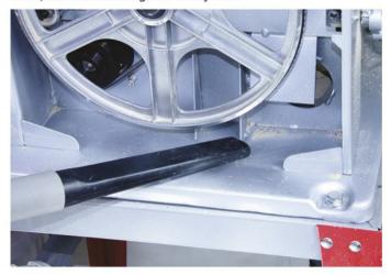
Il est un endroit qu'il est facile d'oublier car hors de la vue. De la sciure s'accumule également sur la structure.
