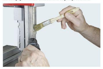
Pour le guide-lame inférieur c'est l'occasion en plus de la poussière de retirer quelques débris de bois qui s'y sont coincés. C'est aussi l'occasion de faire un peu de ménage aux alentours.
