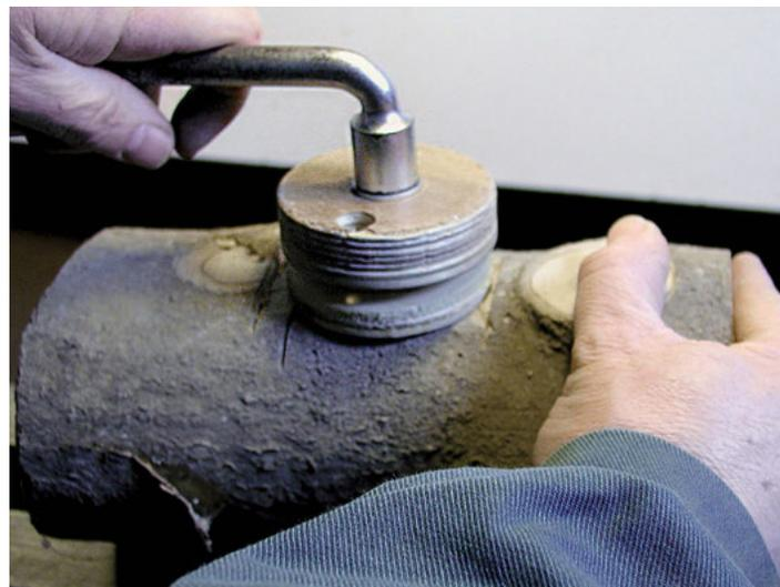
La pièce étant installée sur le tour, utilisez une vitesse de rotation lente pour démarrer. Augmentez la vitesse jusqu'à l'apparition des premières vibrations et réduisez-la d'un cran pour les supprimer. Vous êtes prêt à dégrossir votre ouvrage en toute sécurité.
