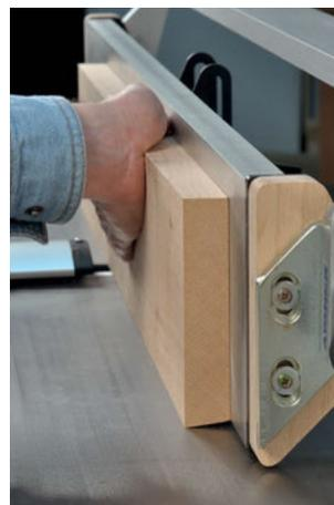
Lors du dégauchissage du chant, les pièces doivent être plaquées fermement contre le guide d'équerre, surtout si leur chant, présentant un biais, les fait s'en éloigner. Il faut donc exercer une pression suffisante contre le guide, avec la paume et les doigts, tout en avançant la pièce.
