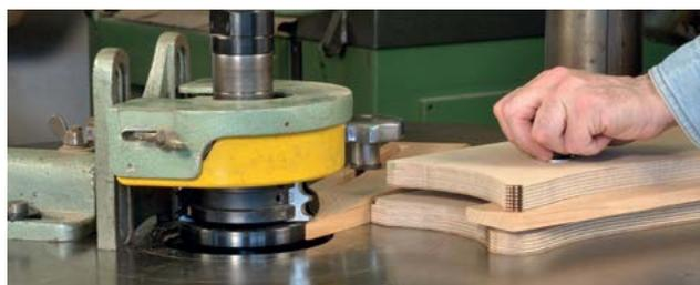
Réglez la butée d'attaque (généralement intégrée au carter) de manière à ce que son sabot de freinage vienne en contact du guide à billes pour empêcher sa rotation.
